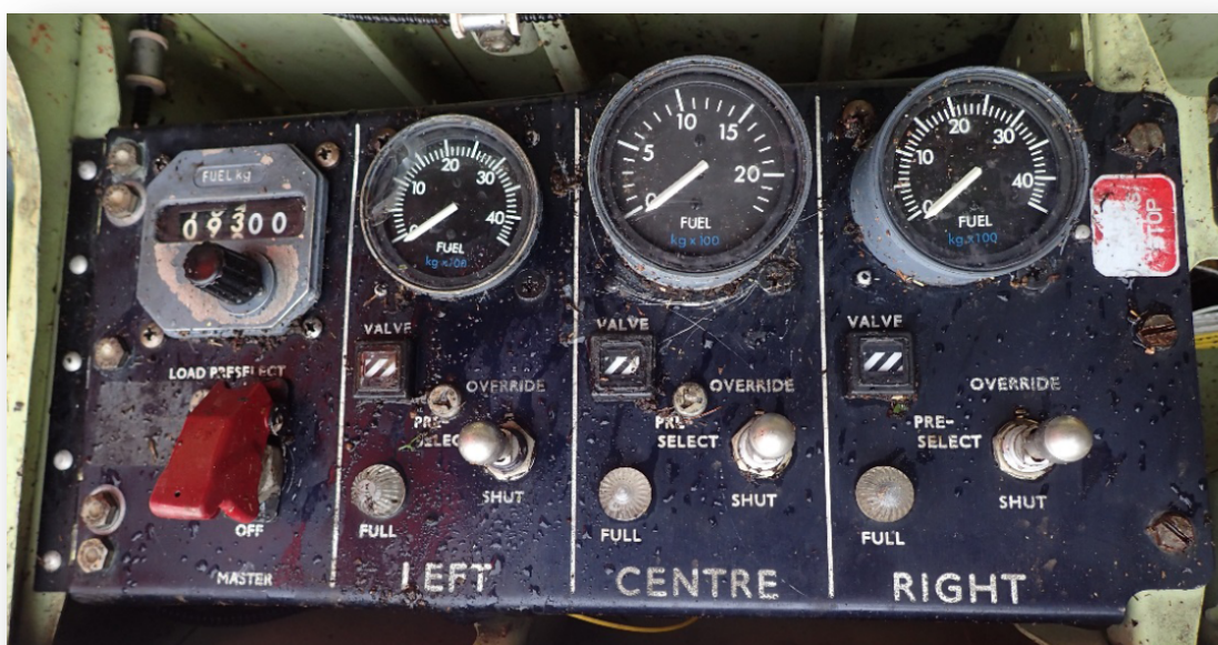
Figura 8 Panel de reaprovisionamiento de combustible
